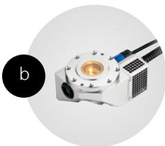
**Die NIR-Spektrometer von Polytec können dank der Multiplexer-Technologie mit bis zu 6 Sonden ausgestattet werden. So kann der Produzent mit einem Spektrometer mehrere Verarbeitungsschritte von der Ernte der Oliven in den Prozess bis zur Pressung und Abfüllung des Olivenöls überwachen.**
