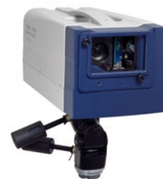
PSV-A-526 Frontfenster schützt die Scan-Einheit
