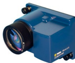
PSV-A-410 Koaxial-Einheit misst an sehr kleinen Prüflingen
