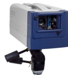
PSV-A-526 Frontfenster schützt die Scan-Einheit
