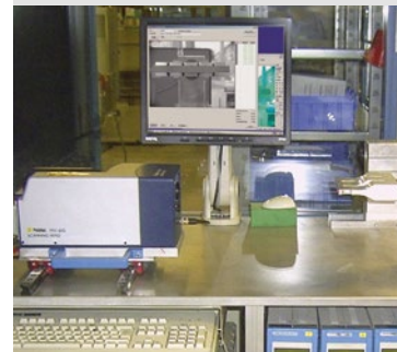
3 Messaufbau zur Charakterisierung der Sonotroden
