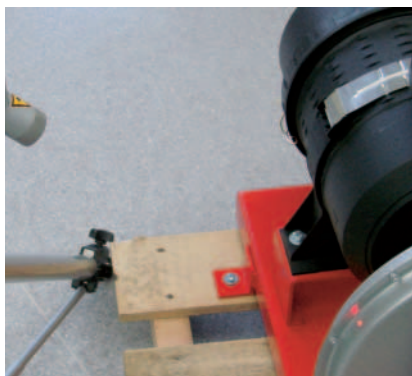
Bild 1: Beispiel für eine Messung mit einem Laservibrometer an einem Elektromotor
