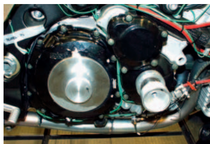
Bild 4: Messpunkte an der Kurbelwelle und Getriebewelle
