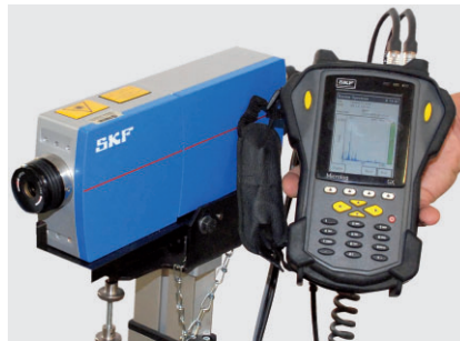
Bild 3: Mobile Systemlösung mit SKF Laservibrometer und SKF Microlog
