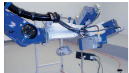
Bild 3: Schwingungsmessung an der Getriebeabdeckung mit RoboVib®
