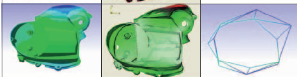
Bild 4: Vergleich der FEA-Moden (links) mit Ergebnissen von RoboVib® (Mitte) und konventionellen Messungen (rechts)
