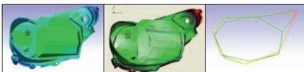
Bild 4: Vergleich der FEA-Moden (links) mit Ergebnissen von RoboVib® (Mitte) und konventionellen Messungen (rechts)
