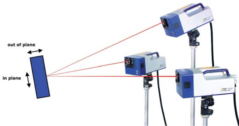
Bild 5: Drei Messköpfe des 3D-Scanning-Vibrometers
