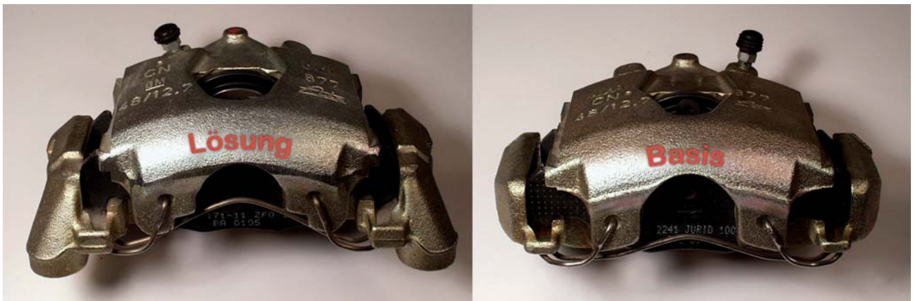
Bild 10: Strukturelle Verstimmung durch Zusatzmassen am Bremssattel (Lösung, links, und Basis, rechts)
