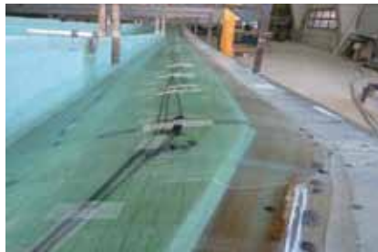
Sensoren vor der Einlaminierung in ein Composite-Bauteil einer Windkraftanlage
