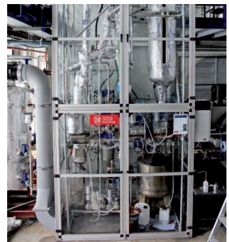
Versuchsstand mit Glattrohrkondensator (TU Braunschweig)
