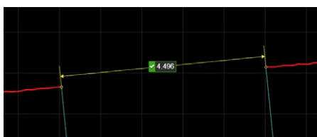
Erfassung und Messung eines Nietlochs mit Gocator®.
