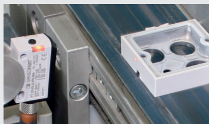
Bild 1: Objekterkennung über einfachen Schaltsensor (links)
