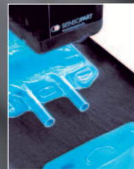
Objektüberprüfung auf Vorhandensein der Kunststofftülle
