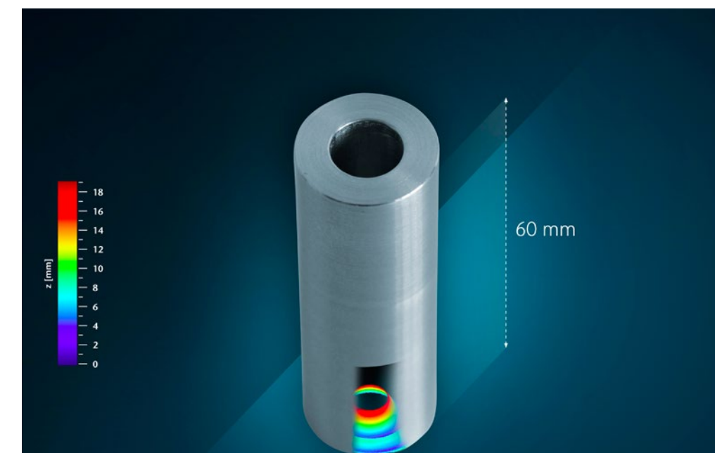
Die TopMap-Systeme bieten Verstellbereiche mit bis zu 70 mm – etwa für das Messen in Bohrungen. Der telezentrische Strahlengang vermeidet Abschattungseffekte.
