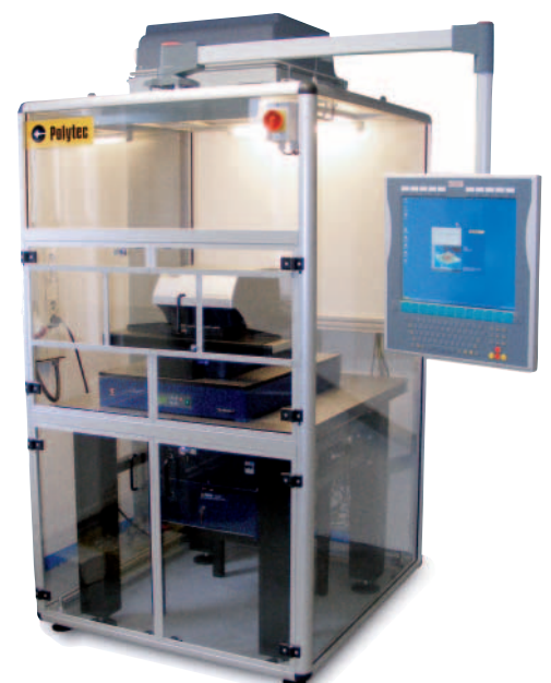
Bild 5: Messstation für TopMap Weißlicht-Interferometer
