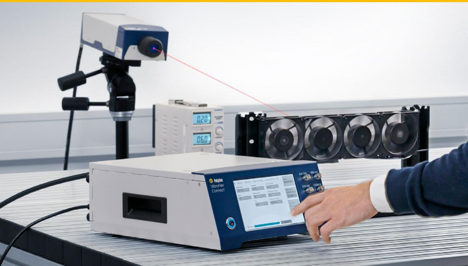
Kern von VibroFlex als flexibles, laserbasiertes Schwingungsmesssystem ist das Frontend Connect. Die neueste Generation FPGA-basierter Signalverarbeitung ermöglicht die synchrone Messwerterfassung von Schwingweg, Schwinggeschwindigkeit und Beschleunigung sowie Signalkonditionierung und bietet Schnittstellen für die digitale und analoge Datenübertragung. Konfigurieren Sie das Frontend Connect für Ihre
